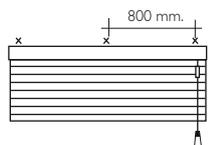
1.- Marque la ubicación de los soportes de instalación, al muro o al techo, perfectamente alineados, y con una separación máxima entre cada uno de 800 mm.
