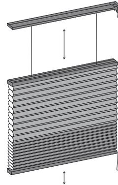
Sistema que permite abrir la cortina de arriba hacia abajo como de abajo hacia arriba, mediante dos frenos independientes, posibilitando dejar la entrada de luz en el espacio deseado.
