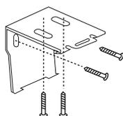
2.- Fije los soportes de instalación al muro o al techo.
