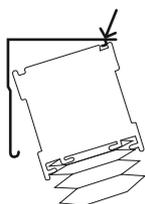
3.- Introduzca la lengüeta frontal del soporte de instalación dentro de la ranura superior del cabezal.
