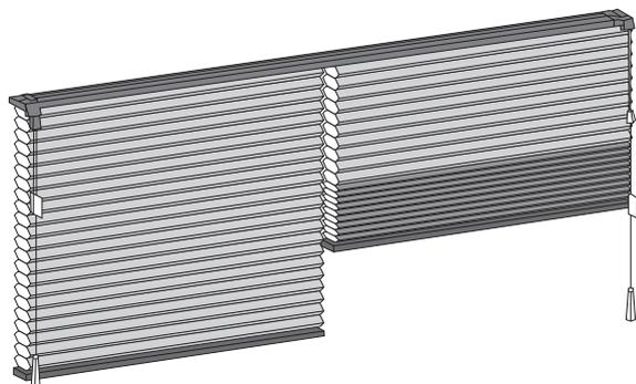
Consiste en dos cortinas estándar que comparten un solo cabezal, que operan con dos frenos en forma independiente. Permite instalar paños de acuerdo a la modulación de las ventanas.
