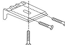
3.- Introduzca la lengüeta frontal del soporte de instalación dentro de la ranura superior del cabezal.
