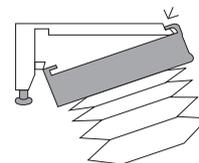
4.- Presione la parte trasera del cabezal hacia arriba, hasta que haga clic. Para el soporte 3/4 fije el tornillo de la patilla trasera.
