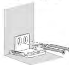
Fijación a muro de vano
