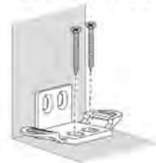
Fijación a piso de vano
