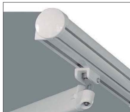
**Palladio 2040** es un toldo con brazos extensibles, sobre barra cuadrada de 40 x 40 mm, en acero galvanizado y pintado, con Cofre y brazos con acero inoxidable. Las dimensiones máximas aconsejadas son de 5000 mm de ancho y 3600 mm de proyección con tubo enrollador de 70 mm. Este modelo viene con un soporte brazo basculante patentado, que permite regular el toldo sin tener que inclinar el cofre.
