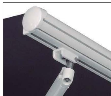
Helix es un toldo con brazos extensibles de aluminio extruido, con cadena de acero inoxidable; soportes laterales fijos e independientes, con sistema de inclinación continuo. Este toldo puede ser instalado a muro, techo o vano. Las dimensiones máximas aconsejadas son de 5000 mm de ancho y 3100 mm de proyección con tubo enrollador de 70 mm de diámetro.
